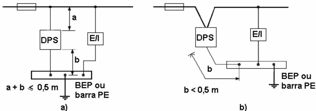
**Dimensionamento:** o DPS deve ser da classe tipo II, com fixação em trilhos DIN 35 ou garras NEMA. Obrigatoriamente deve possuir proteção interna, visando garantir a continuidade do fornecimento de energia elétrica contra os efeitos do curto circuito permanente do varistor (fim de sua vida útil) conforme NBR IEC 61643.
